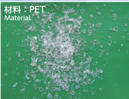
FS 処理前 約15000ppm Pre treatment Applox. 15000ppm
